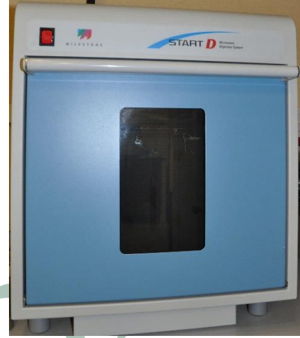
Şekil 2. Mikrodalga yaş yakma cihazı görseli
